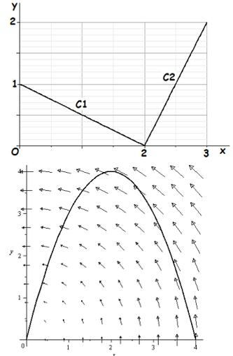
10. Determine as integrais  $\int \vec{F} \cdot d\vec{r}$  e  $\int \vec{F} \times d\vec{r}$  onde  $\vec{F} = -y\vec{i} + x\vec{j}$ , no caminho definido pela equação  $y = (4-x)x$  de  $(0, 0)$  até  $(4, 0)$ .
